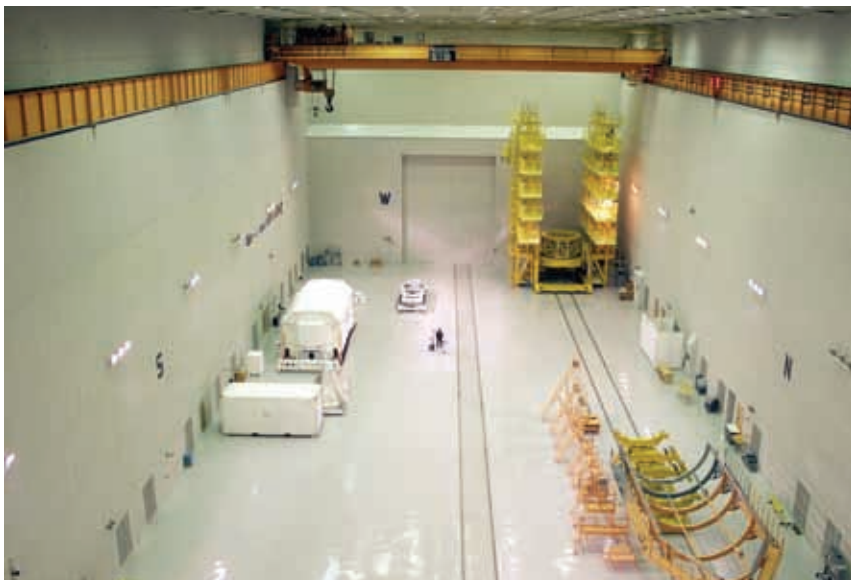
Космодром Байконур. Самое большое в мире ЧП класса ИСО 8 (110 × 30 × 26 м). Эксплуатируется с 1998 года для коммерческих пусков
