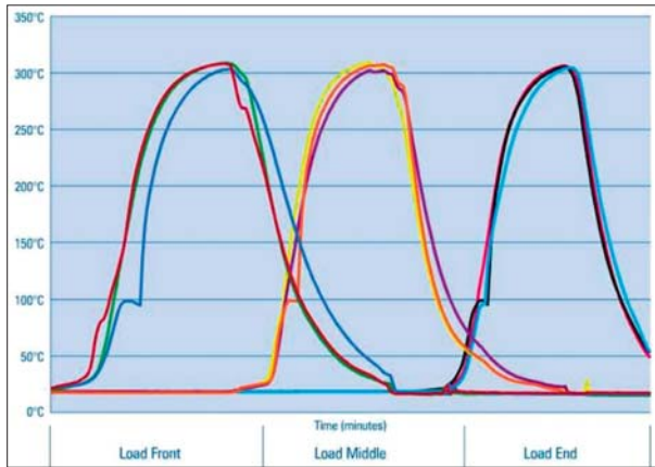
Рис. 3. Пример температурных профилей для испытаний переднего ряда, середины и последнего ряда контейнеров [9]
