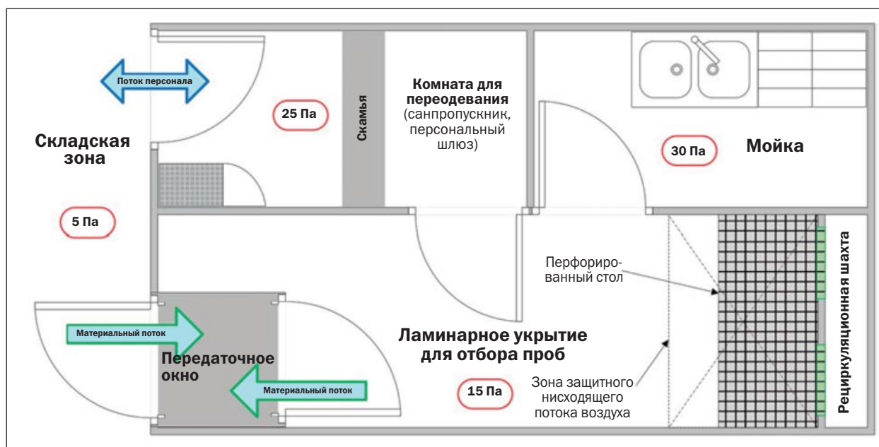
Рис. 2. Пример организации комплекса помещений для отбора проб [2]
